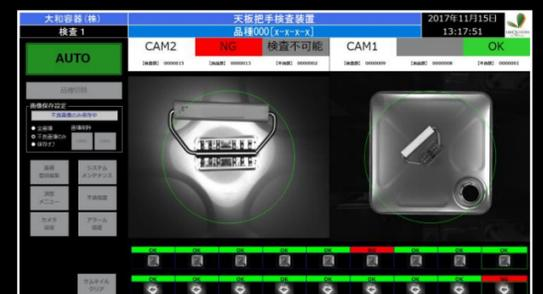
◆既存ラインに設置可能。(取付寸法:コンベア幅500 装置サイズ:W1500mm×D750mm×T1800mm)
